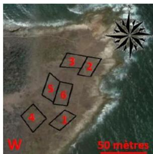
Six placettes de 20 m x 30 m sont disposées sur chacune des stations. Le périmètre de la zone d'étude est délimité par des piquets et de la corde. Chaque angle a été photographié et géo référencé afin de permettre la mise en place d'un suivi régulier sur les mêmes stations.
