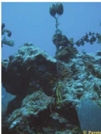
Cette sonde permet d'enregistrer en continu (pas de temps de 60 min) les valeurs de la température de l'eau afin d'enrichir les connaissances sur les variations saisonnières et inter-annuelles et également de mettre en place un protocole d'alerte lié au réchauffement des eaux pouvant conduire à un phénomène de blanchissement des coraux (PARETO 2013).
