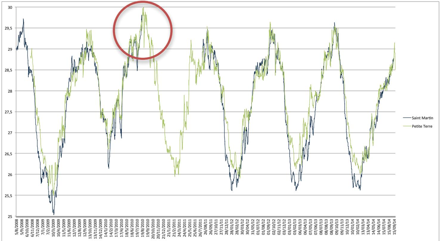
Figure 64 : Courbe des températures issues des sondes des réserves de Saint-Martin et de Petite Terre depuis 2008 (entouré en rouge, anomalie de température 2010 déclenchant le « bleaching warning »)
